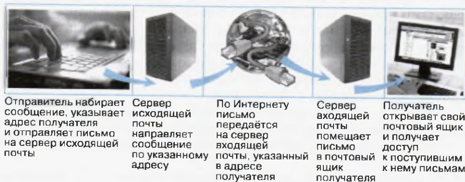
Рис. 4.5. Схема работы электронной почты
