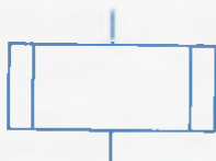
Рис. 2.5. Блок «предопределённый процесс»
