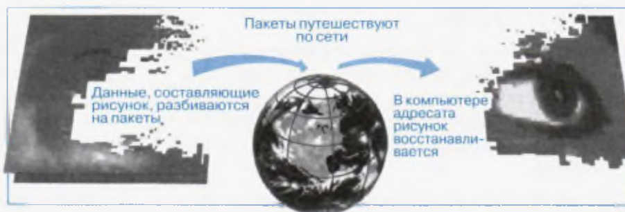
Рис. 4.4. Пакетная передача данных
