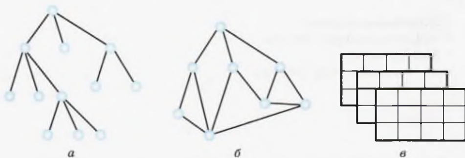
Рис. 1.14. Модели организации данных в БД: a — иерархическая, б — сетевая, в — реляционная
