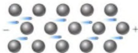
Рис. 28. В металлических кристаллических решётках подвижные электроны под действием электрического поля перемещаются, создавая электрический ток
