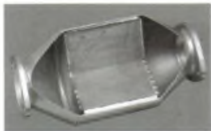
Рис. 16. Каталитический преобразователь автомобиля, превращающий оксиды азота его выхлопных газов в безвредный азот
