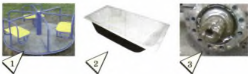
Рис. 45. Защита металлов от коррозии. Защитные покрытия: 1 — краски; 2 — эмали; 3 — смазки
