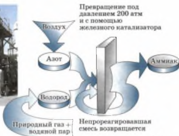
Рис. 131. Промышленная установка (а) и схема промышленного получения аммиака (б)
