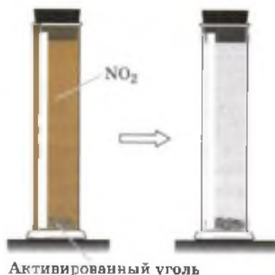
Рис. 147. Адсорбция оксида азота (IV) активированным углём
