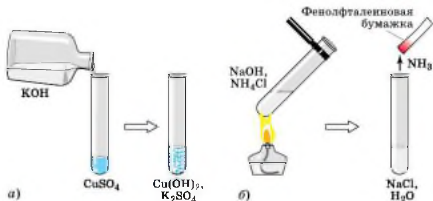
Рис. 140. Взаимодействие щелочей с солями: а — с образованием осадка; б — с образованием газа
