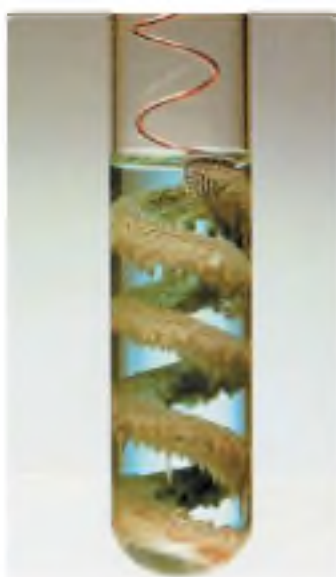
Рис. 105. Кристаллы серебра, выделившиеся на медной проволоке в результате реакции замещения меди в растворе нитрата серебра
