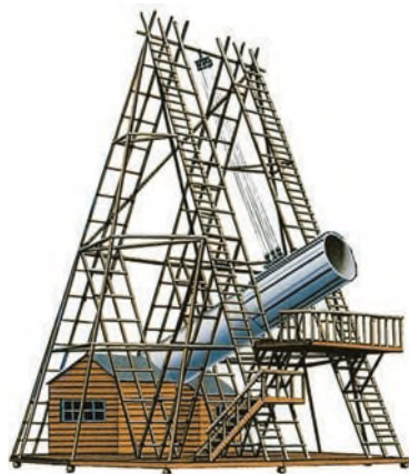
Рис. 49. Первый большой телескоп Гершеля с зеркалом диаметром 1,2 м
