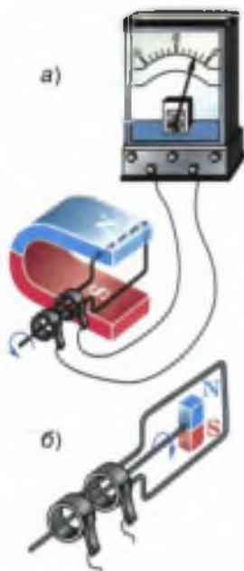
Рис. 121. При вращении контура в магнитном поле (магнита относительно контура) изменение магнитного потока приводит к возникновению индукционного тока
