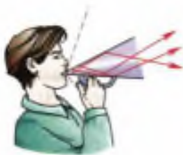
Рис. 82. Принцип действия рупора
