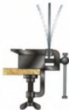
Рис. 74. Пример источника звука
