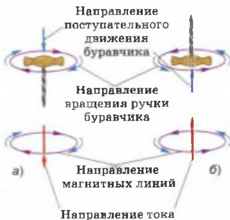
Рис. 96. Применение правила буравчика: проводник с током расположен в плоскости чертежа
