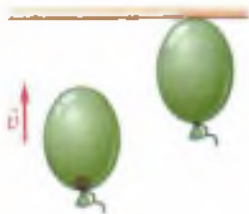
Рис. 20. Опыт, свидетельствующий о том, что ускорение, получаемое телом, зависит от массы тела
