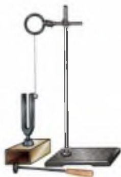
Рис. 76. Обнаружение колебаний ветвей звучащего камертона
