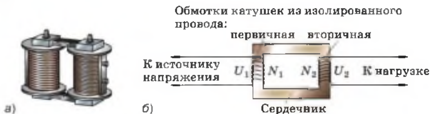
Рис. 134. Внешний вид и схема устройства повышающего трансформатора
