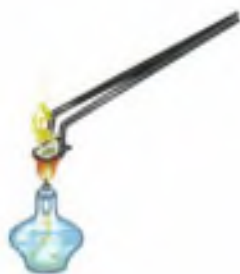
Рис. 153. При внесении в пламя газовой горелки кусочка поваренной соли пламя окрасится в жёлтый цвет
