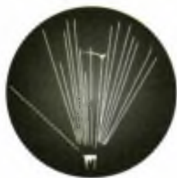
Рис. 161. Фотография треков заряженных частиц, полученных в камере Вильсона
