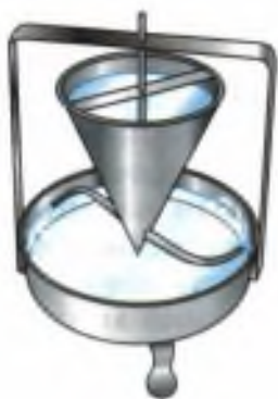
Рис. 46. Демонстрация реактивного движения с помощью сегверова колеса
