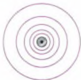
Рис. 89. Магнитные линии магнитного поля, созданного прямолинейным проводником с током
