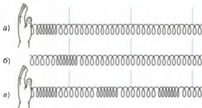
Рис. 69. Возникновение волны в пружине
