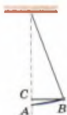
Рис. 59. При колебаниях с малой амплитудой длина дуги AB равна отрезку AB
