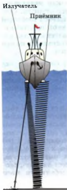
Рис. 78. Использование ультразвуковых колебаний для измерения глубины моря
