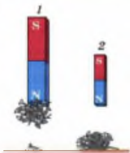
Рис. 111. Магнитное поле первого магнита сильнее, чем второго
