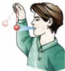
Рис. 83. Пример механического резонанса
