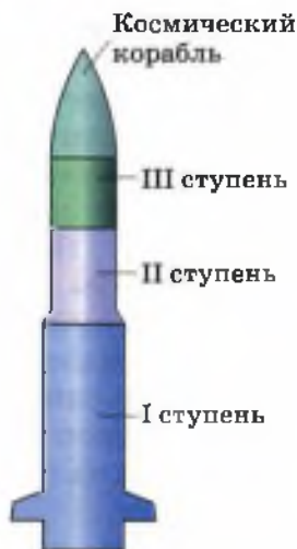
Рис. 49. Схема трёхступенчатой ракеты
