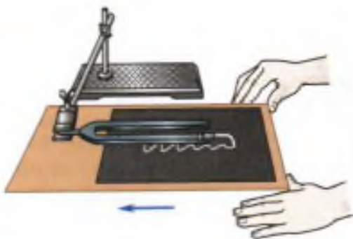
Рис. 77. Запись колебаний ветви камертона
