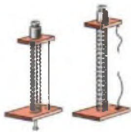
Рис. 192. Совершение работы сжатой пружиной при её распрямлении
