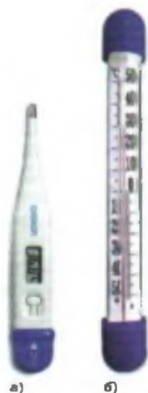
Рис. 11. Термометры: а — электронный; б — спиртовой
