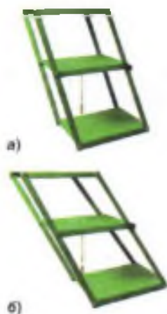
Рис. 190. Равновесие призмы на шарнирах: а — устойчивое; б — неустойчивое
