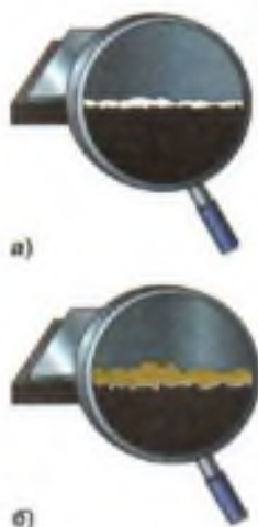
Рис. 82. Уменьшение силы трения с помощью смазки
