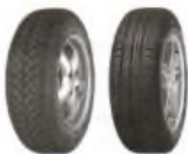
Рис. 86. Ребристые выступы на шинах позволяют увеличить трение
