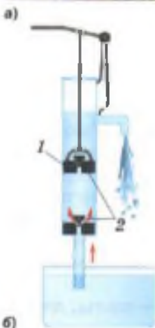
Рис. 142. Колонка с поршневым насосом: а — внешний вид; б — устройство
