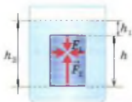
Рис. 148. Силы, действующие на погружённое в жидкость тело
