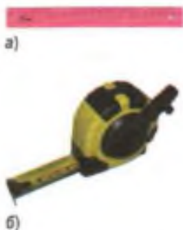
Рис. 6. Приборы для измерения длины: а — линейка; б — рулетка
