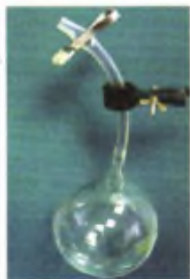
Рис. 124. Шар для взвешивания воздуха
