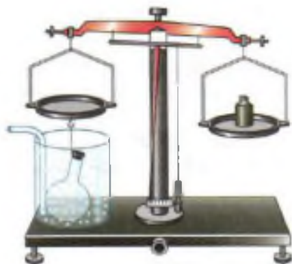
Рис. 150. Обнаружение силы, выталкивающей тело из газа
