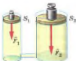
Рис. 144. Принцип действия гидравлической машины
