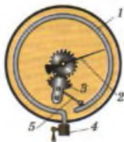
Рис. 141. Устройство металлического манометра
