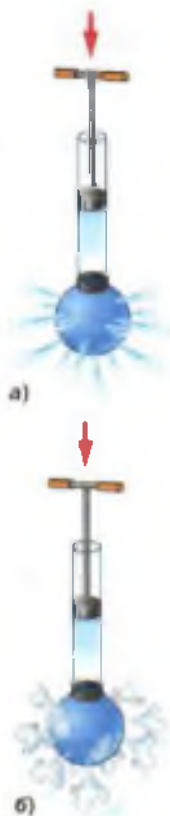
Рис. 100. Передача давления во все стороны без изменений: а — жидкостями; б — газами
