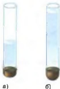
Рис. 106. Прогибание плёнки при увеличении столба воды
