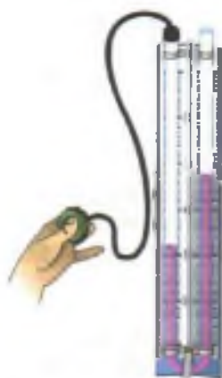
Рис. 138. Изменение уровня жидкости в коленах манометра
