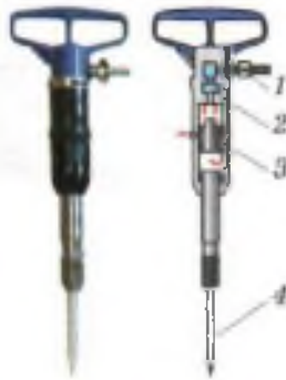
Рис. 104. Внешний вид и устройство пневматического молотка
