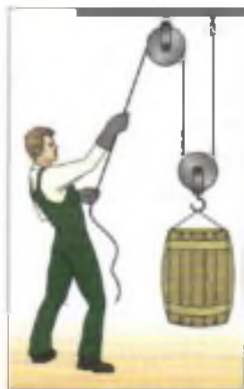
Рис. 181. Комбинация подвижных и неподвижных блоков — полиспаст
